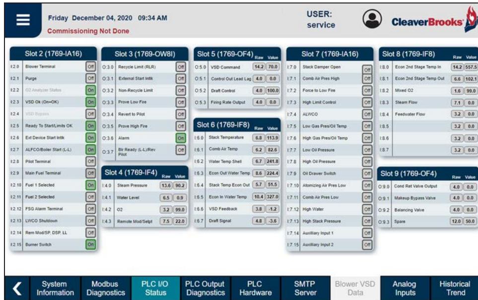
Figura 6-13. Estado de E/S del PLC
