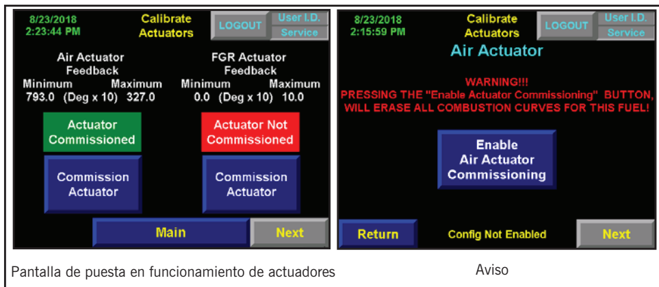
Figura 5-2. Puesta en funcionamiento de actuadores
