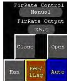
Figura 3-21 Control de la tasa de encendido
