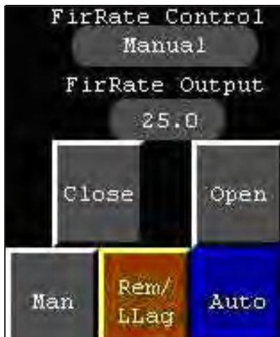
Figura 3-10 Detalles de la pantalla de configuración de ajuste de O2 (Control de la tasa de encendido)
